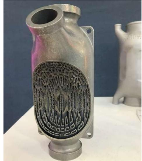
Trend zu hochintegrierten Systemkomponenten (hier: Hydraulikventilblöcke APWORKS, Wärmetauscher CONFLUX)
