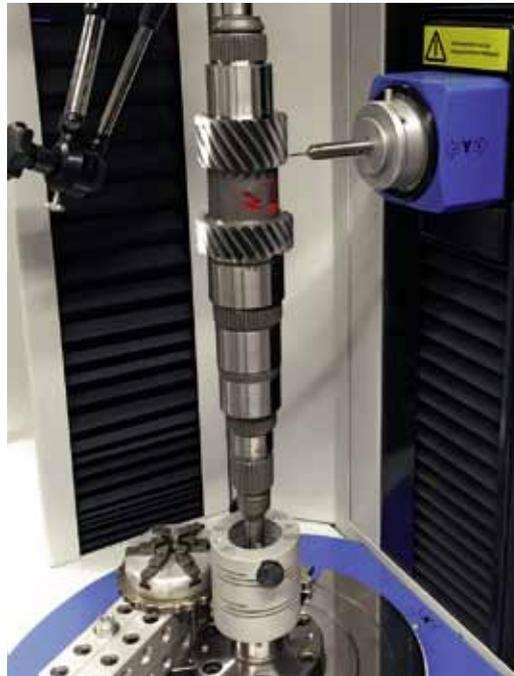
*Welligkeitsmessung eines Zahnrades auf einer Getriebewelle*
