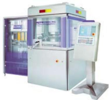
Innovatives Maschinensystem mit Tablettenpresse, Schaltschrank und Bedienungsterminal
